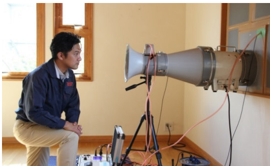
全棟高性能保証表示システム (プラン確定時に断熱性能を示すQ値・U値を計算、お引渡し時に全棟気密性能C値を実測し、住まいの性能を確認します。)
